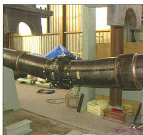
ECS-PJ 曲げ試験の様子
