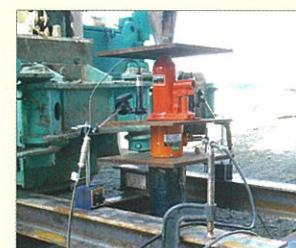
押込み支持力試験
