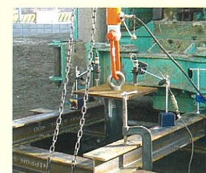
引抜き支持力試験
